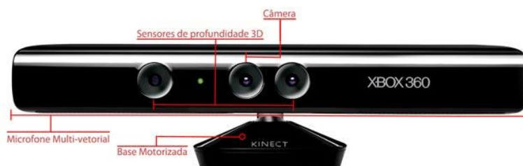
Figura 2. Imagem mostrando detalhes do Microsoft Kinect [Canaltech 2015].
