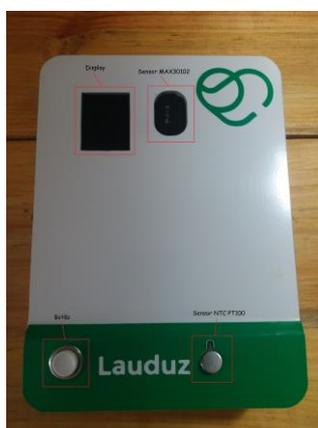
Figura 5. Imagem da parte superior do protótipo
