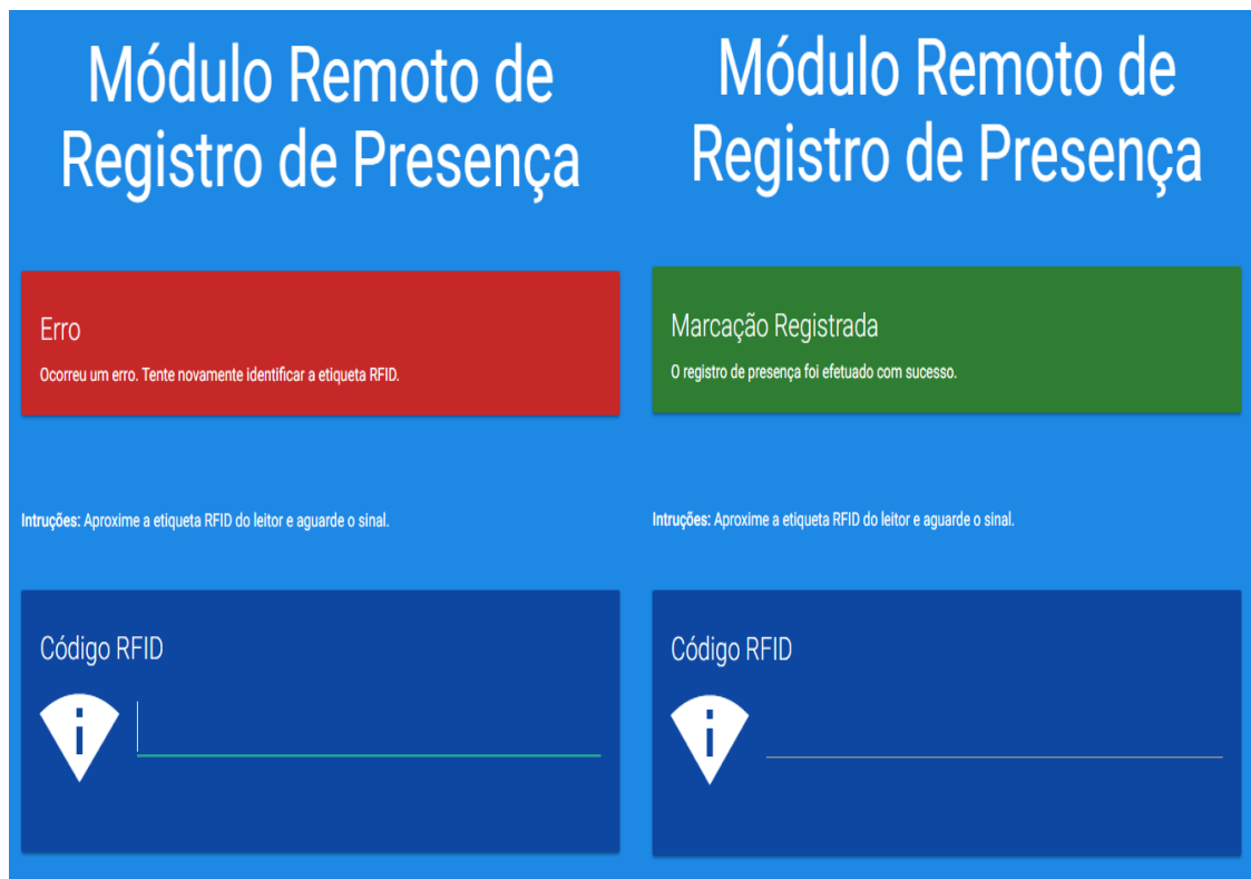
Figura 13. Interface do Módulo de Registro de Presença com Erro e Confirmação de Leitura da Tag .
