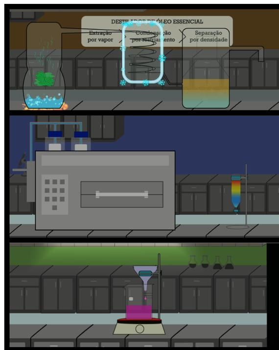
Figura 3. As mudanças dos personagens são representados por técnicas usadas em laboratório. Como mostrado na imagem, de cima para baixo temos: destilação a vapor, cromatografia líquida de alta eficiência seguido de cromatografia de coluna e aparato para obtenção de nanopartículas. Fonte: Elaborado pelo autor.
