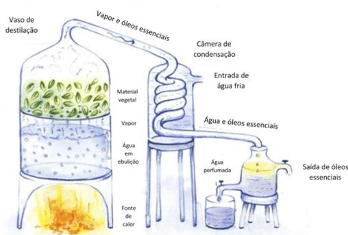
Figura 1. Destilação a vapor para extração de óleos essenciais. Fonte: Retirado de BetaEQ(2019)[4].
