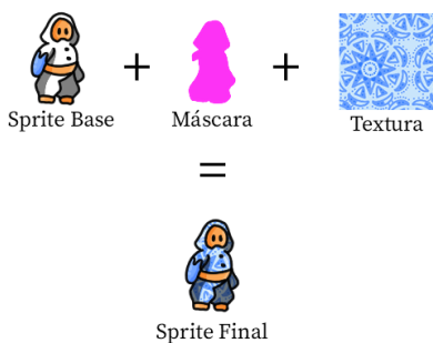
Figura 11. Exemplo da implementação da união da sprite base, sprite de máscara e sprite de textura através do intermédio de um shader para a criação da sprite final.
