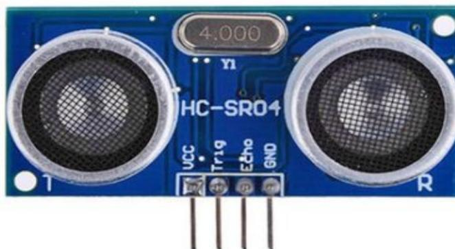
Figura 2. Sensor ultrassônico [Bertoleti 2017]
